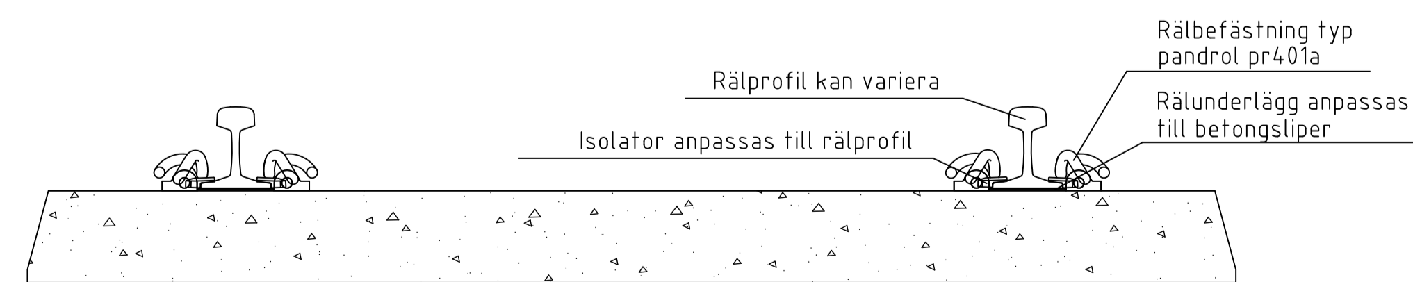
DETALJ 2 BETONGSLIPERS MED PANDROLBEFÄSTNING SKALA: 1:10
